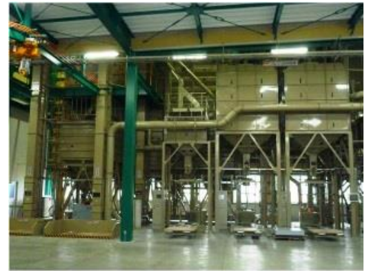
玄米集荷プラント。集荷した玄米をフレコンに詰めを行います。
