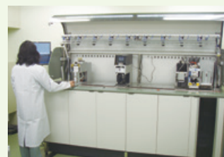
紙質の確認 (自動紙質測定器オートライン 400)
